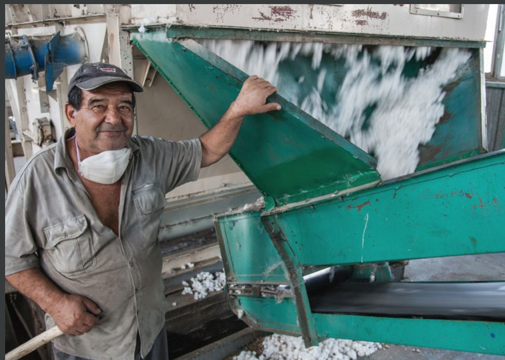
Arstan Aydoruliev in der Gin prüft den Materialfluss. In der Gin wird das Saatkorn von der Faser getrennt. Die Maschinen müssen vor Verarbeitung der Bio-Baumwolle gut gereinigt werden.
